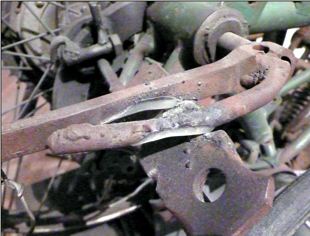
Abbildung 1: Verschleisssschicht aus Epoxidharz an einem stark reibenden Pedal nach zwei Jahren Ausstellungsbetrieb.
