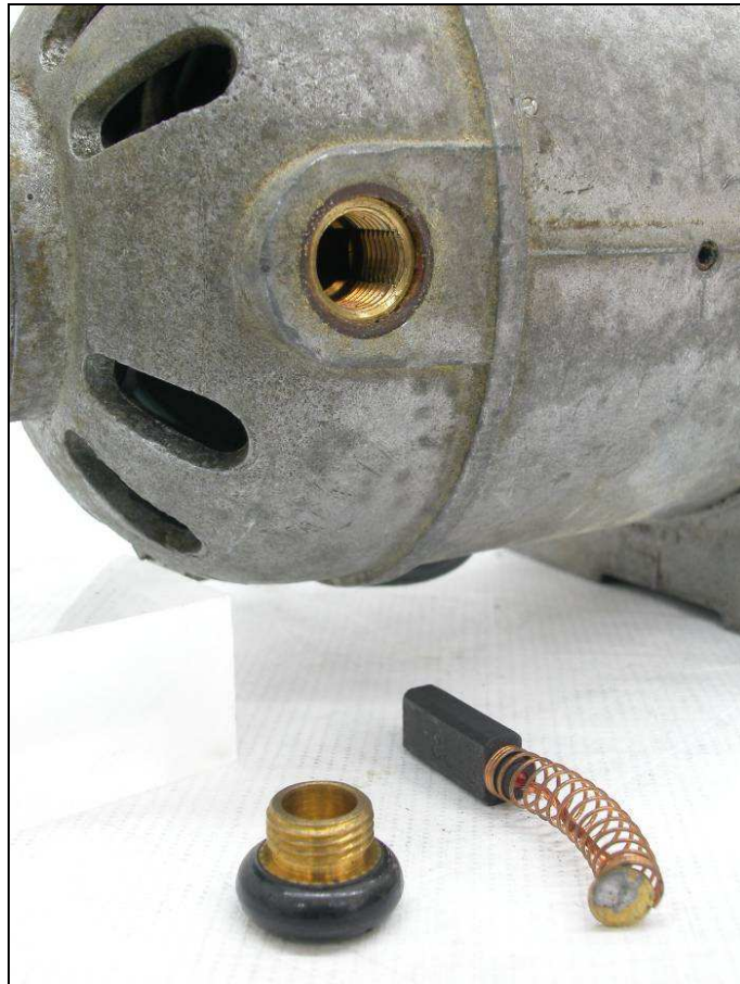
Abbildung 5: Demontierte Kohlenbürste mit Anpressfeder
