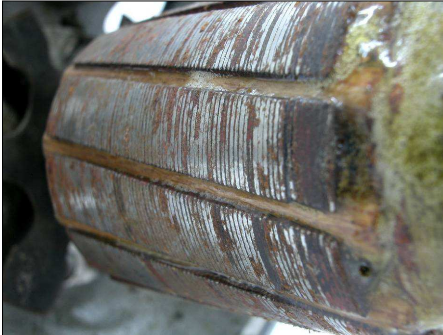
Abbildung 48: Korrosion der Bleche am Läufer eines Universalmotors.
