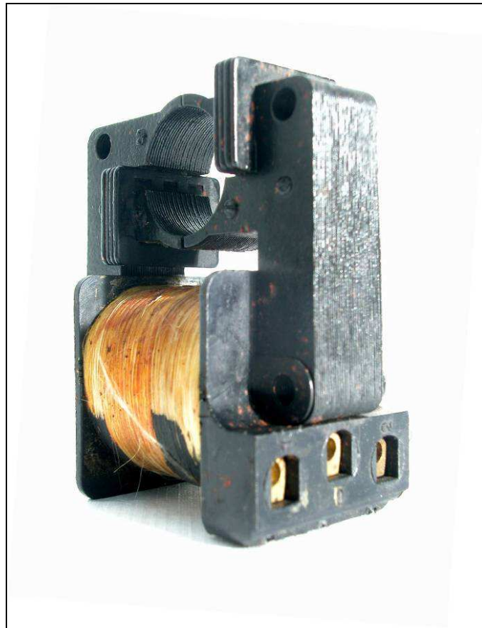
Abbildung 45: Unten: Hauptwicklung und Eisenkern mit Anschlussklemmen. Oben: Hauptpole und Spaltpole mit Kurzschlusswicklungen
