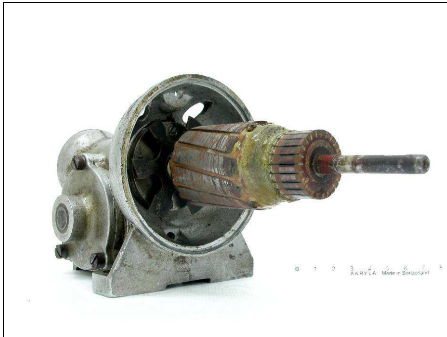
Abbildung 11: Vorderes Lagerschild mit dem Läufer und dem Stromwender (Kommutator)
