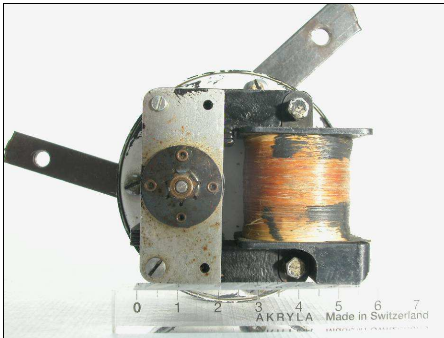
Abbildung 35: Rückseite des Motors. Links der runde Läufer, der vom Eisenkern umfasst wird. Rechts wird der Eisenkern von der Hauptwicklung umfasst.
