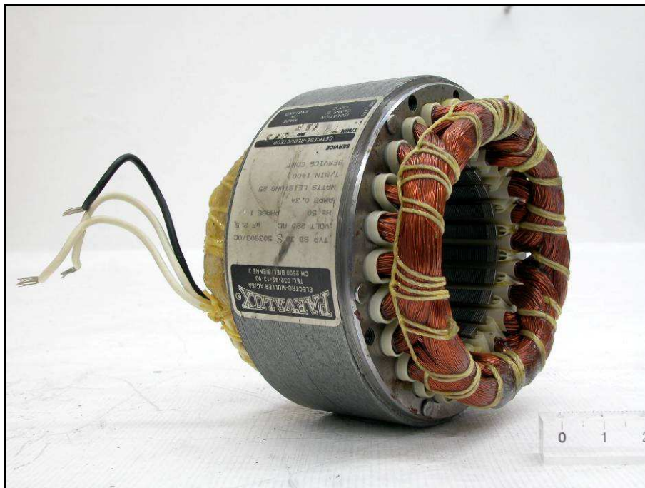
Abbildung 23: Stator mit Wicklung für Drehstrom um 120^\circ versetzt (3 Phasen).
