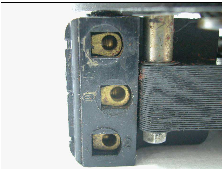
Abbildung 36: Anschlussklemmen: 0 und 1 für 127 Volt / 0 und 2 für 220 Volt.
