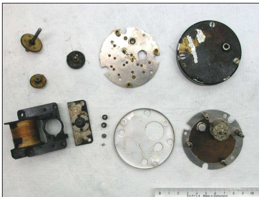
Abbildung 46: Alle Teile des Spaltpolmotors.
