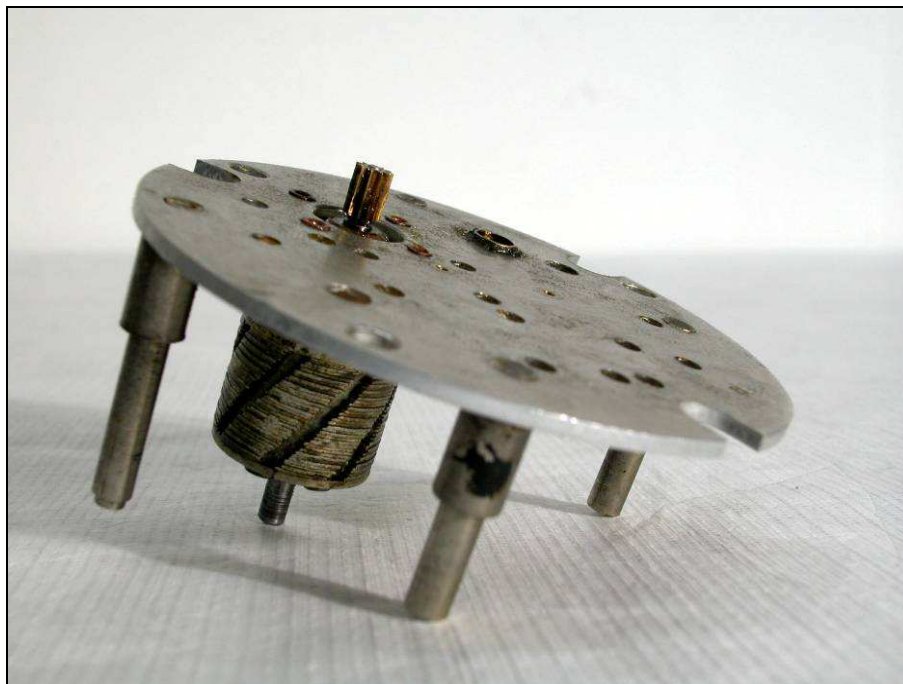
Abbildung 42: Grundplatte mit dem Kurzschlussläufer und dessen Antriebszahnrad.
