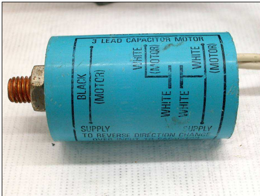
Fig. 21. Wiring diagram of condenser.
