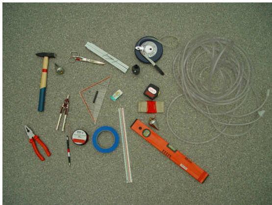
Abb. 26: Werkzeug für das Handaufmaß
