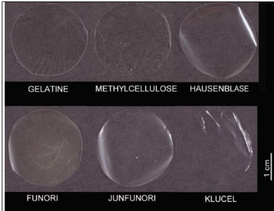
Abb. 23: Klebstofffilme aller Klebstoffe mit 1 % Massegehalt nach Ablösen von den Petrischalen aus Polystyrol (PS).
