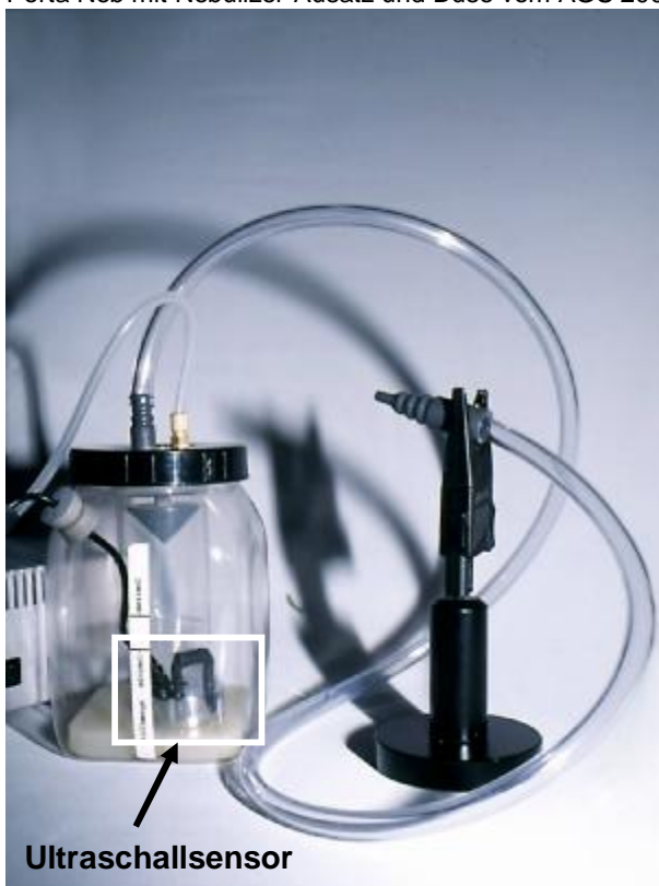
Mini-Vernebler WAV mit Vierkantflasche und Schlauch zum Transport des Nebels und schwarzer Düse.
