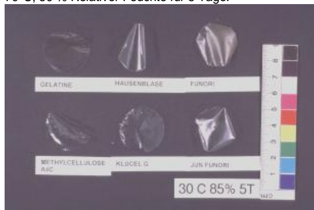
Klebstofffilme nach der beschleunigten Alterung bei 30°C, 85 % Relativer Feuchte für 5 Tage.
